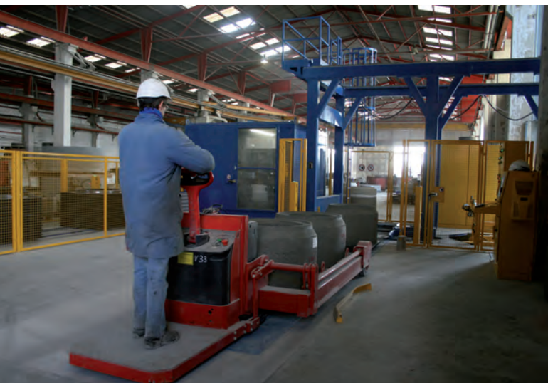
Транспортировка набравших прочность продуктов к станции погрузки с помощью отвозящей тележки
